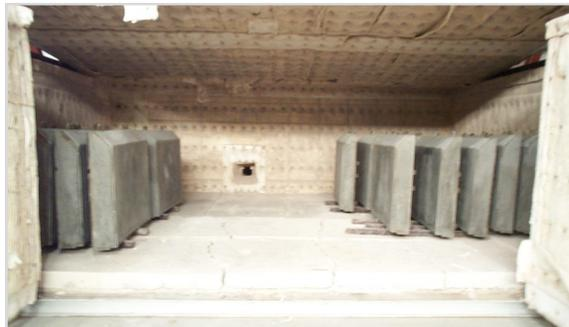
Piezas Prefabricadas de Pared Exterior
