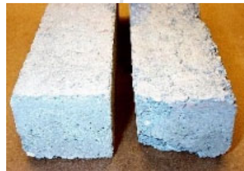
TUFFLOOR® Concreto Estándar Ciclo térmico a 1400°F (760°C)
