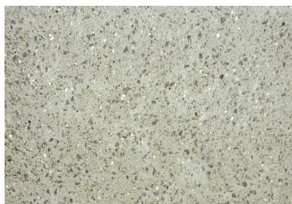
Corte transversal de un pedazo de TUFFCRETE® 60 X shotcreteado
